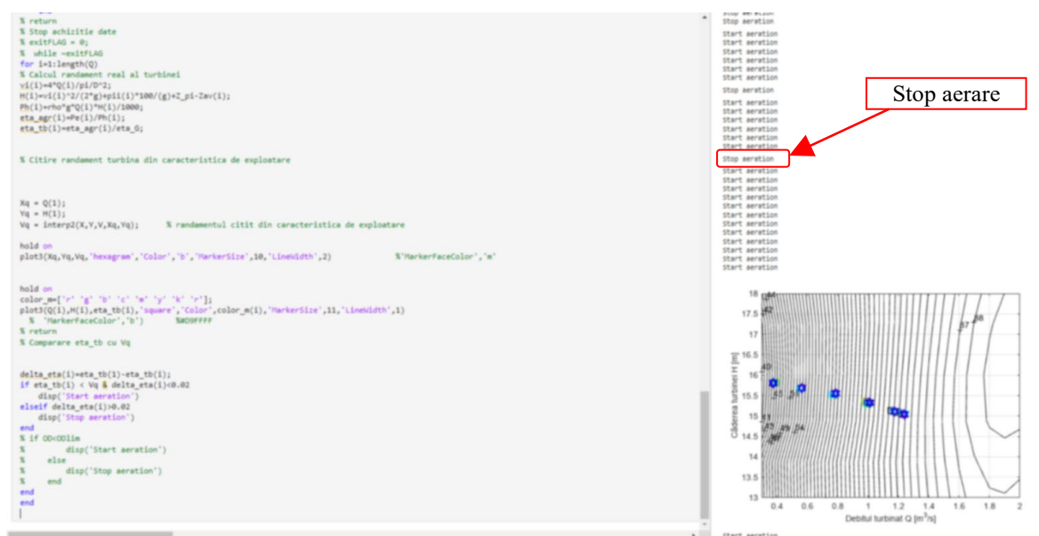
Fig. 2. Rularea programului în Matlab realizat pentru testarea algoritmului de optimizare a performanțelor turbinei
